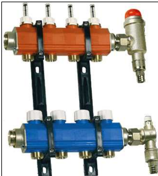
5.ábra: Műanyag 2 légkamrás osztó-gyűjtő, légtelenítővel, ürítővel áramlásmérővel
